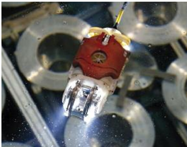
El robot Pez Luna ha explorado el reactor 3 de Fukushima y tomado las primeras fotos e imágenes.
