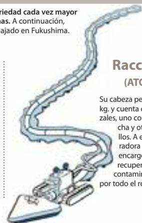
Su cabeza pesa más de 35 kg. y cuenta con dos cabezales, uno con forma de flecha y otro con cepillos. A este robot-aspiradora gigante se le encargó la misión de recuperar el "polvo" contaminado esparcido por todo el reactor 2.
