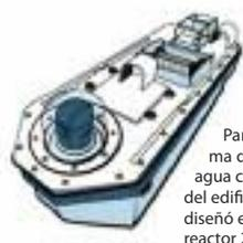
Para comprobar el estado del sistema de refrigeración que contiene el agua contaminada en la parte más baja del edificio de contención nuclear, Hitachi diseñó este robot para inspeccionar el reactor 2.
