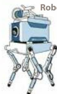
Alcanza la velocidad de 1 km/h y tiene una autonomía de dos horas. Cuenta con una cámara y un medidor de radiactividad. Además, puede subir escaleras, lo que le permitirá acceder a las zonas más dañadas por el tsunami. Su capacidad de carga es de 20 kilos.
