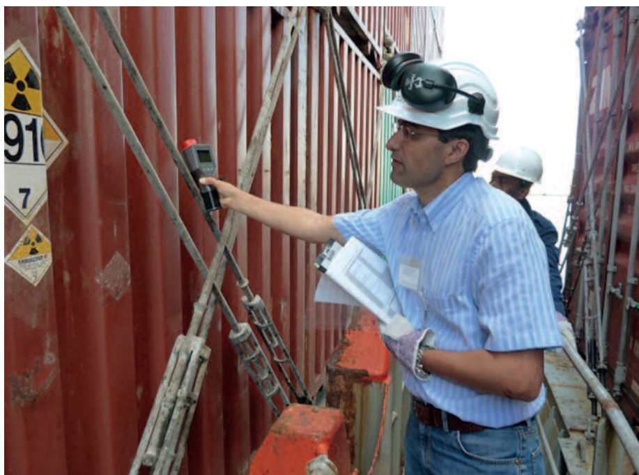
Un inspector con encomienda de funciones durante el examen de un contenedor marítimo con una fuente de Cobalto-60.
