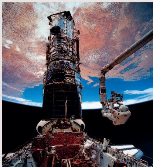
El telescopio espacial Hubble amarrado en la bodega del transbordador Endeavour durante la primera misión de reparación del observatorio en órbita, en 1993, con los astronautas Story Musgrave y Jeffrey Hoffman trabajando en el exterior de la nave.
