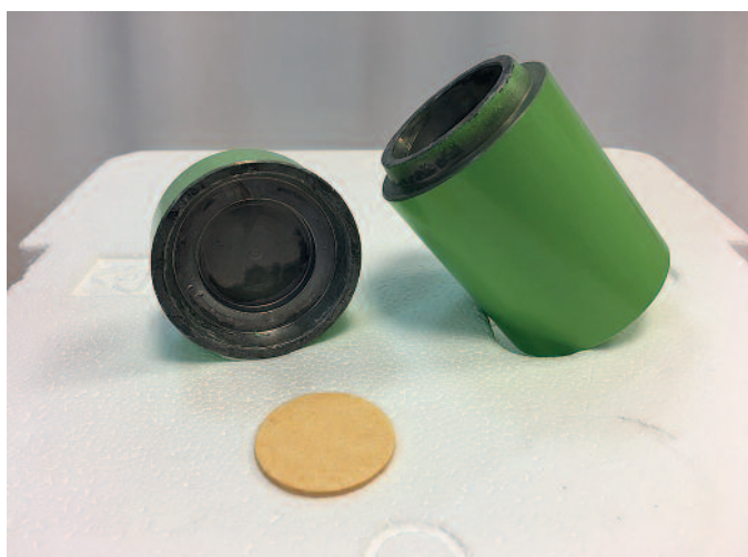
Los 'targets' de uranio-235 son irradiados en el reactor BR2 y luego enviados a una instalación de procesamiento en el Instituto Nacional de Radioelementos de Bélgica (IRE), donde se extrae el isótopo, en este caso el molibdeno-99, por un proceso de fisión.
