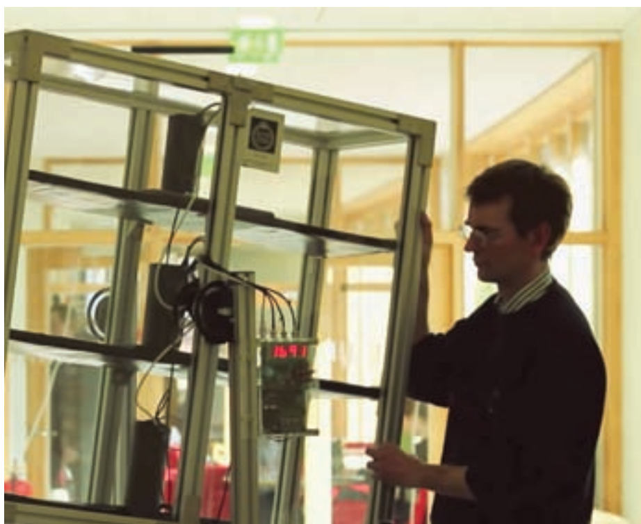
Aparato con el que recogen la radiación gamma y convierten las frecuencias en notas musicales.
