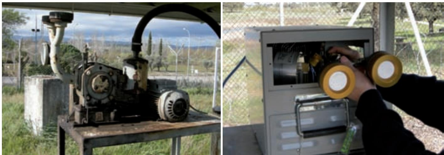
Cabezas de equipos de muestreo de aire del sistema PVRA. A la izquierda, modelo anterior a 1985, a la derecha, modelo actual.
