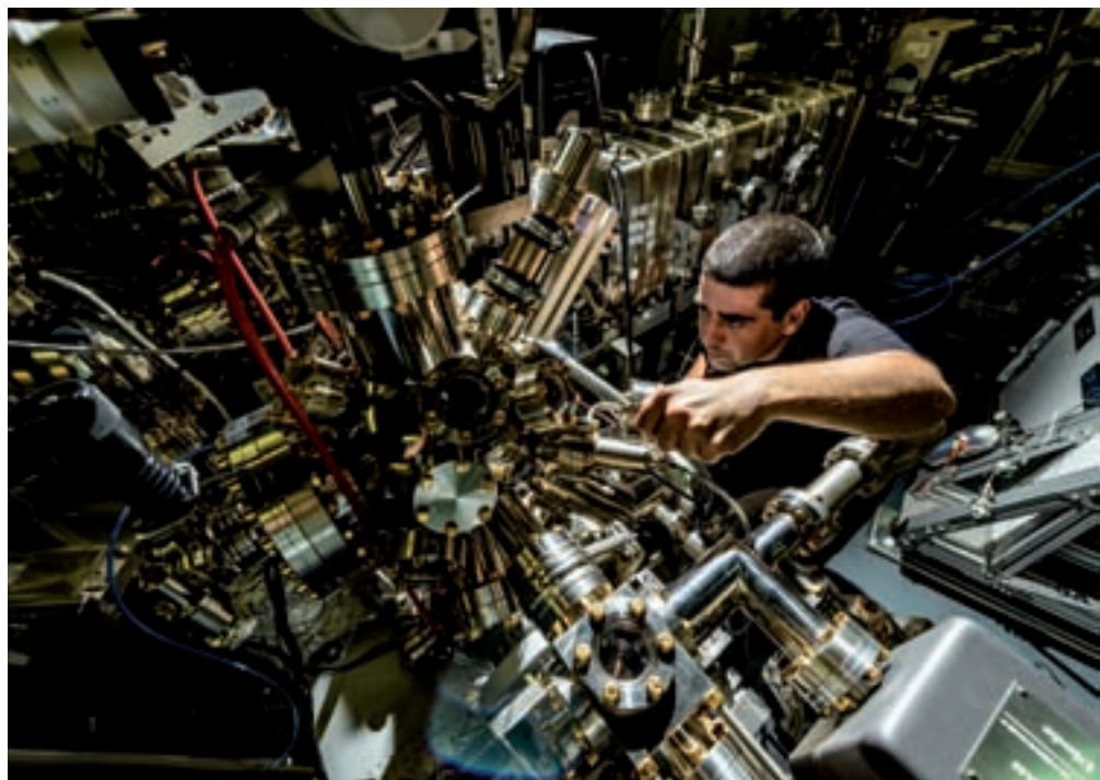
Estación experimental de la línea de luz CIRCE, dedicada a estudiar las propiedades electrónicas de los materiales y reacciones químicas en catálisis.
