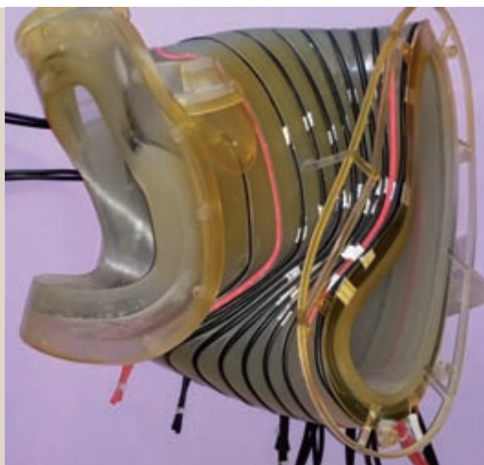
Pieza de stellarator generada mediante impresión 3D en el Ciemat.
