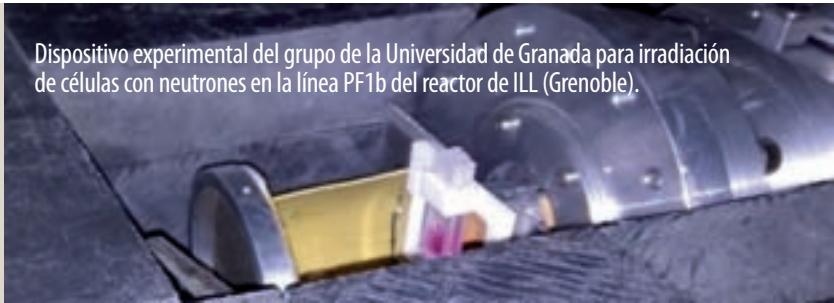
Dispositivo experimental del grupo de la Universidad de Granada para irradiación de células con neutrones en la línea PF1b del reactor de ILL (Grenoble).
