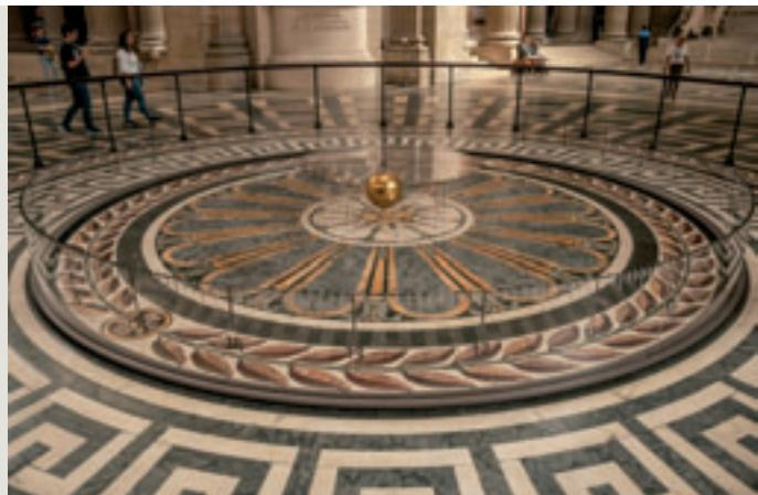
posición de esta marca cambió, siendo evidente así que la Tierra debía girar sobre su propio eje. El Péndulo de Foucault sigue siendo, a día de hoy, una de las maneras más simples y elegantes de demostrar el movimiento del planeta y la diferente rotación entre los polos y el ecuador, donde el péndulo permanece siempre en el mismo plano sin llegar a girar.
