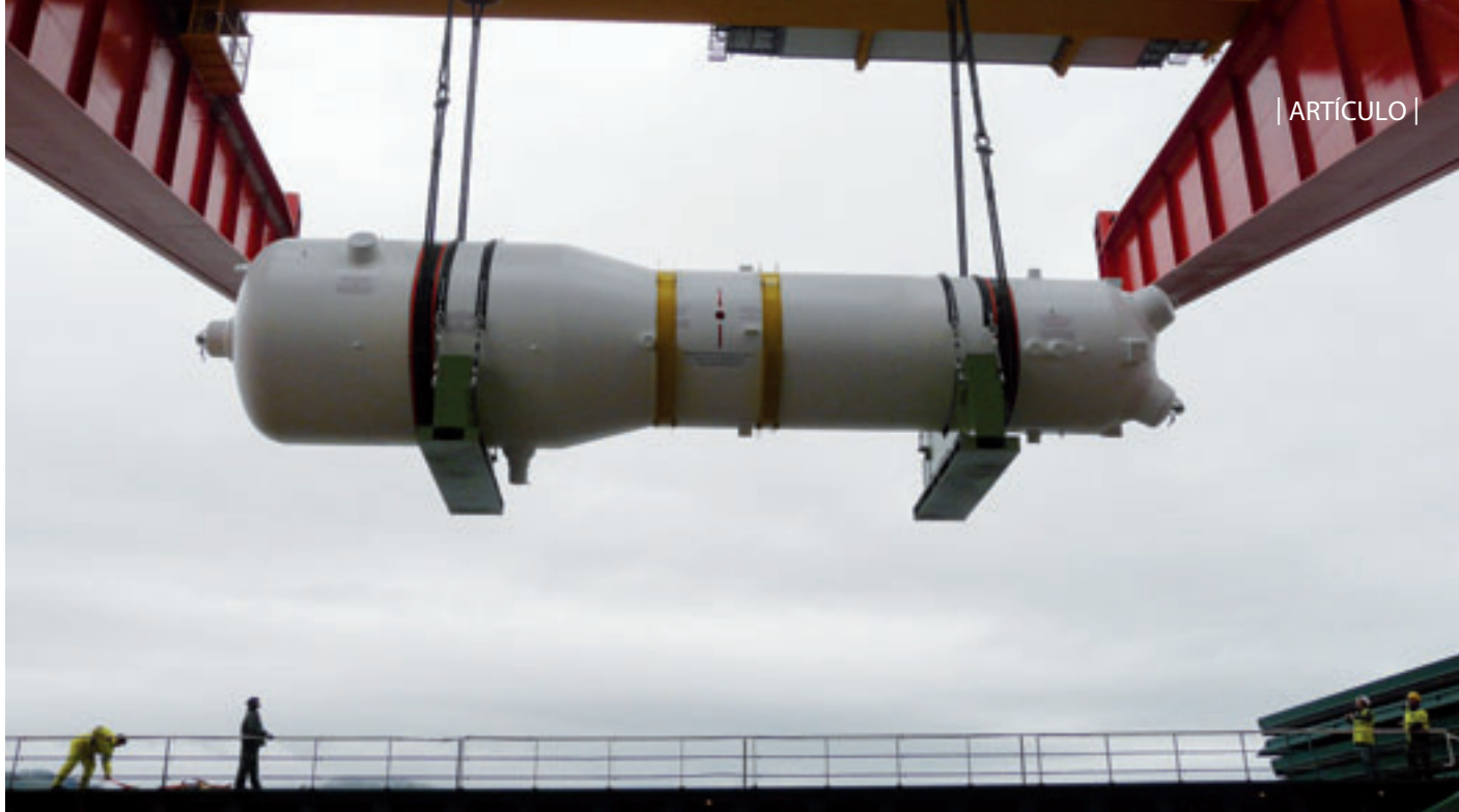
Transporte de un generador de vapor fabricado por la empresa española Equipos Nucleares (ENSA).
