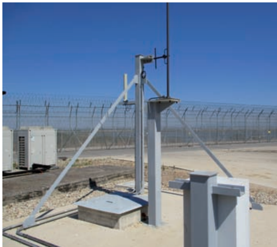
Sonda para medida de la radiación gamma ambiental de la central nuclear Almaraz.
