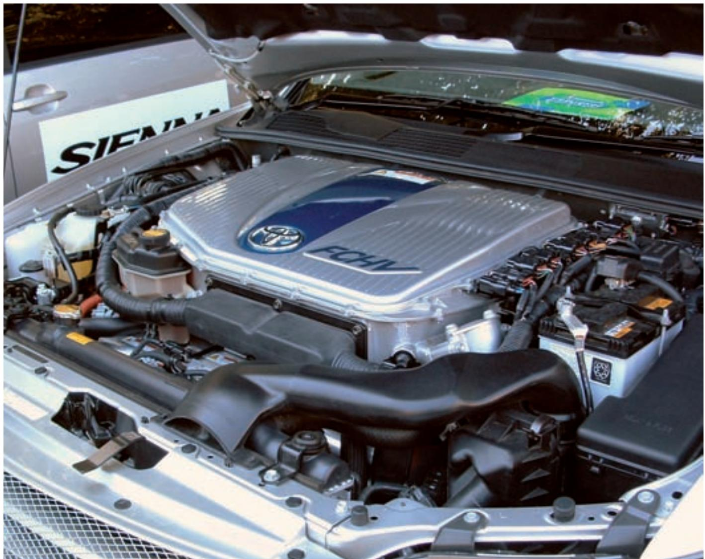
Motor de célula de combustible instalado en un vehículo de la marca Toyota.
