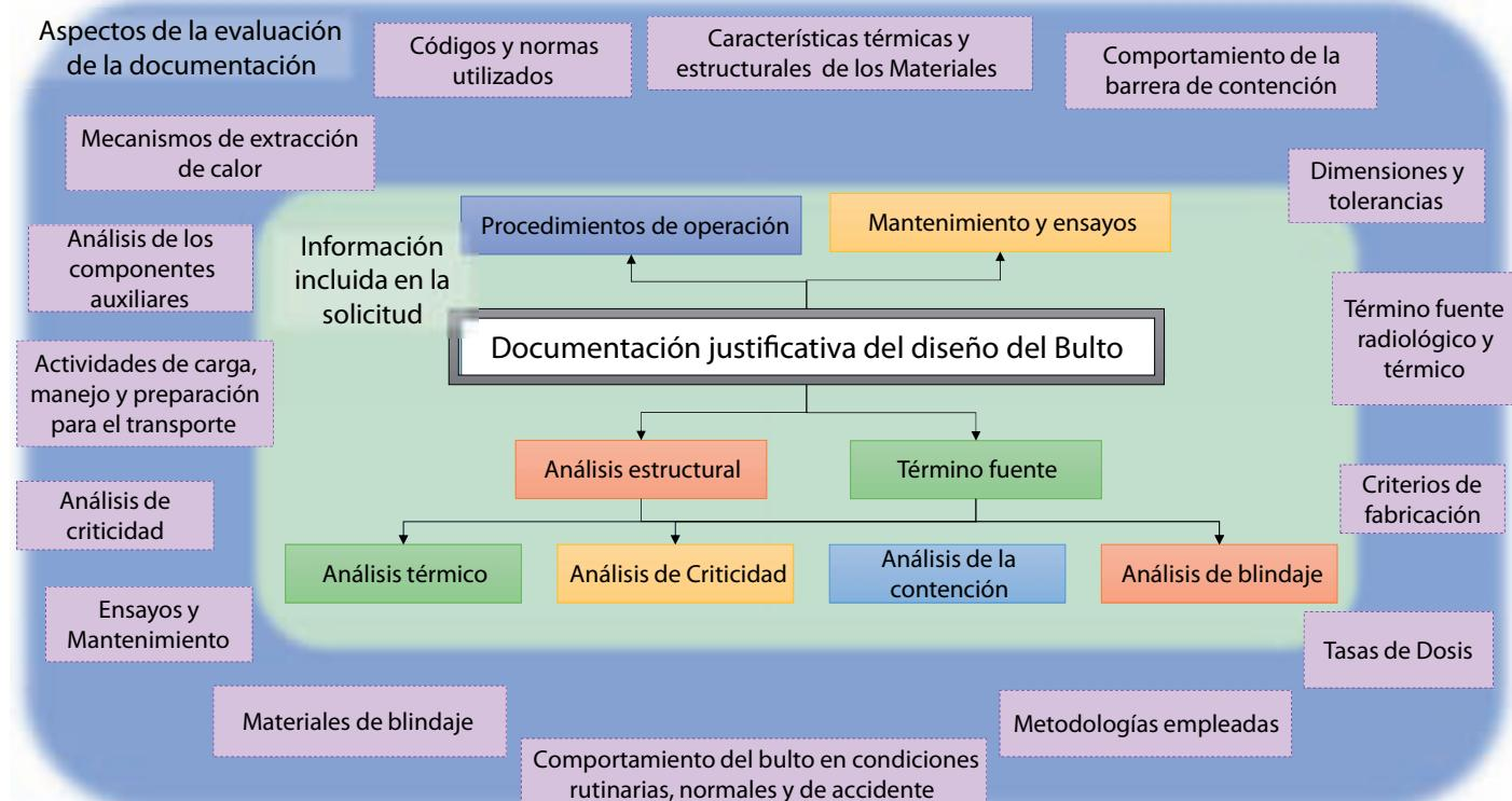
Figura 1: Aspectos de la evaluación de un bulto de transporte de combustible gastado.
