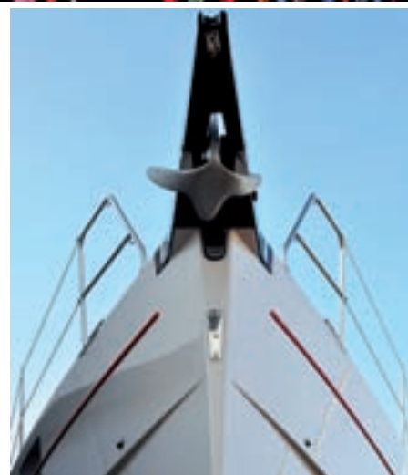
Arriba, vidrieras góticas hechas con vidrio. Abajo, casco de barco hecho con fibra de vidrio.
