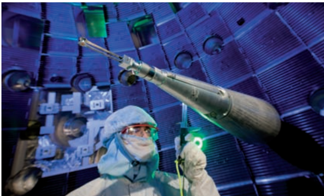
Un operador comprueba el brazo en cuyo extremo se sitúa el cilindro con la bola de combustible, dentro de la cámara de ignición.
