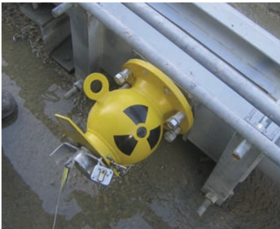
Fuente radiactiva encapsulada para control de procesos.
