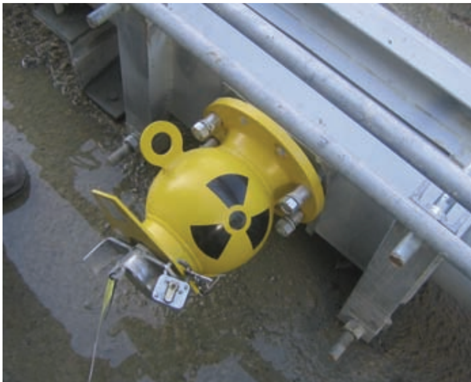
Fuente radiactiva encapsulada para control de procesos.
