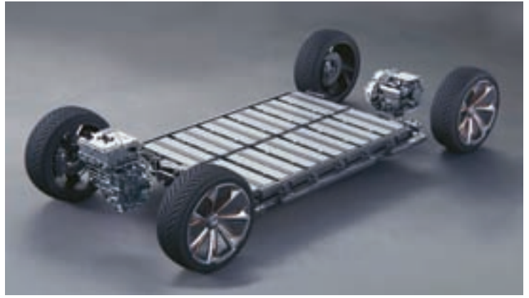
Batería de litio de un coche eléctrico y conexiones de alimentación. Derecha, batería de níquel de Tesla y la Universidad Dalhousie, montada en un prototipo.
