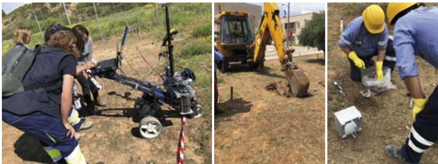
Medidas espectrométricas y toma de muestras de suelos.
