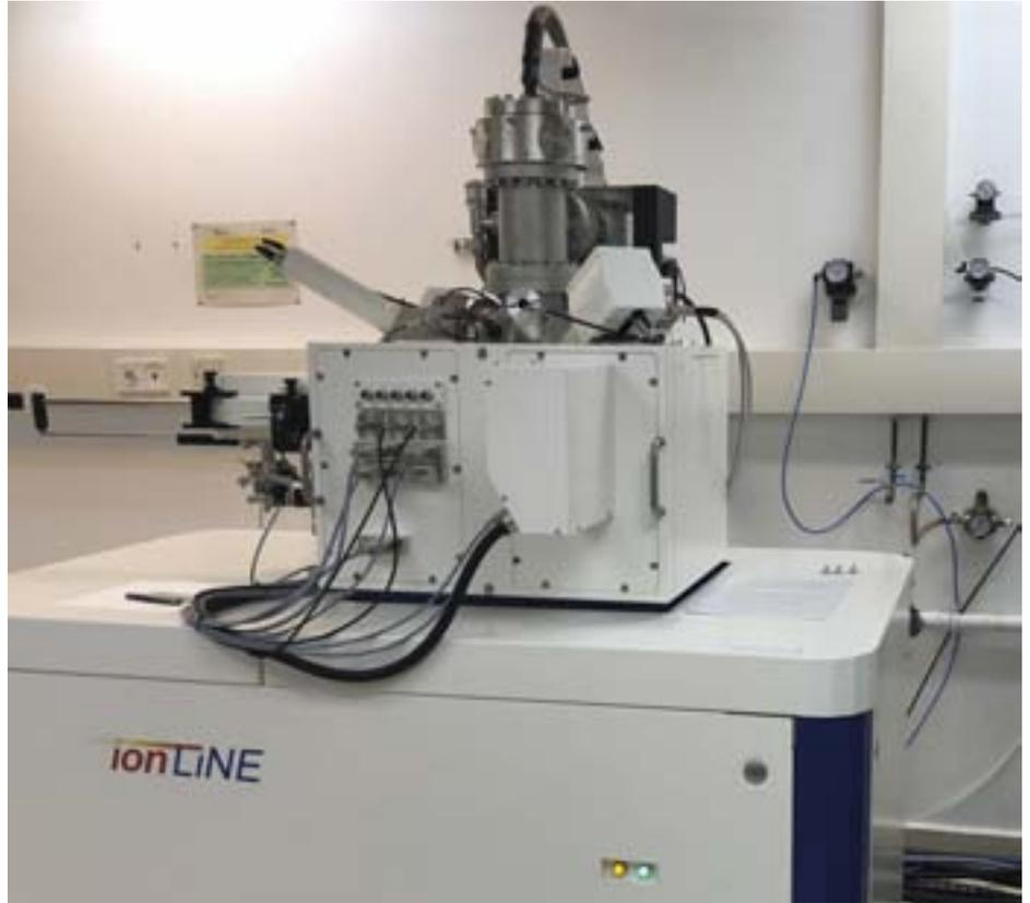
Equipo de litografía por haz de iones.
