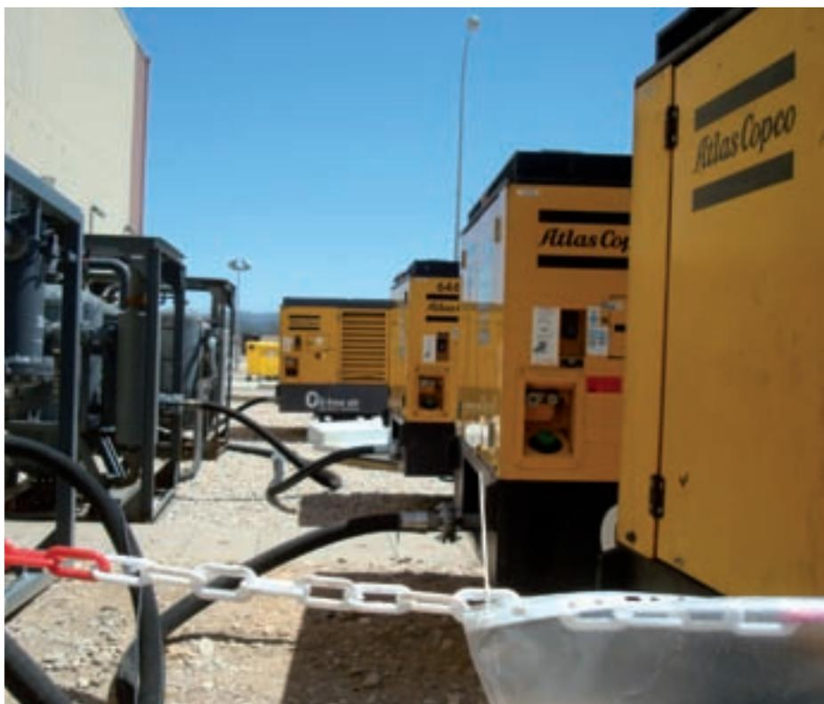
Compresores y secadores de aire empleados en la presurización del RC en una prueba ILRT.
