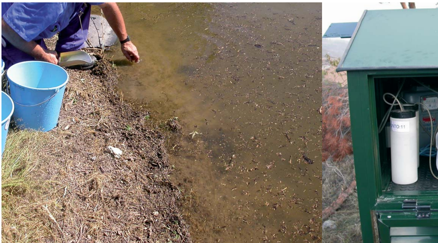
Toma de muestras de sedimentos (izquierda) y aire (centro). Dosímetros (derecha).
