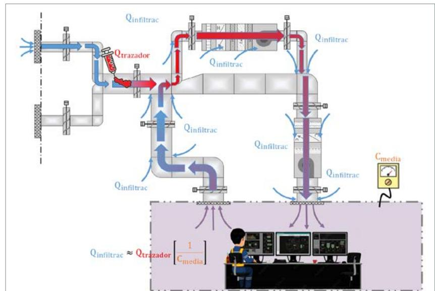
Figura 6. Diseño esquemático del método de inyección constante
