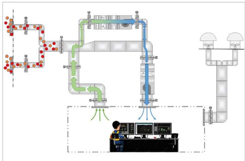
Figura 4. Funcionamiento en modo recirculación (tóxicos)
