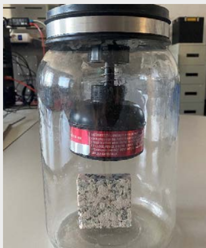
Jarra con el material de construcción y los detectores de radón de electrete y trazas. (fuente: elaboración propia)
