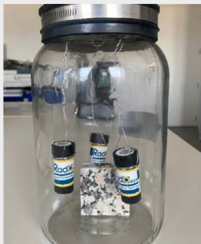
Jarra con el material de construcción y los detectores de radón de electrete y trazas. (fuente: elaboración propia)
