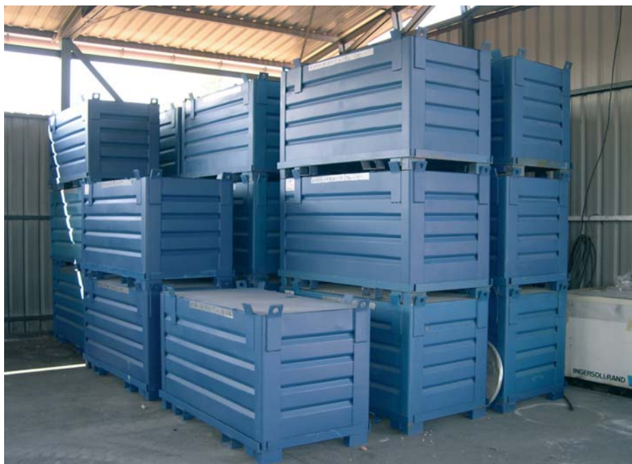
Contenedores metálicos de transporte (CMT) para residuos radiactivos metálicos.
