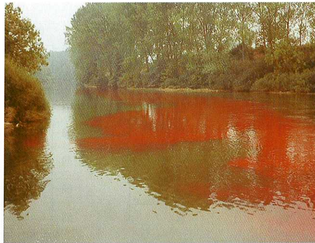
► Figura 4. Mancha de trazador en las proximidades del punto de inyección en una de las campañas realizadas en el río Ebro.
