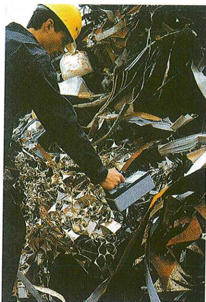
► Figura 2. Inspección radiológica de un montón de chatarra.
