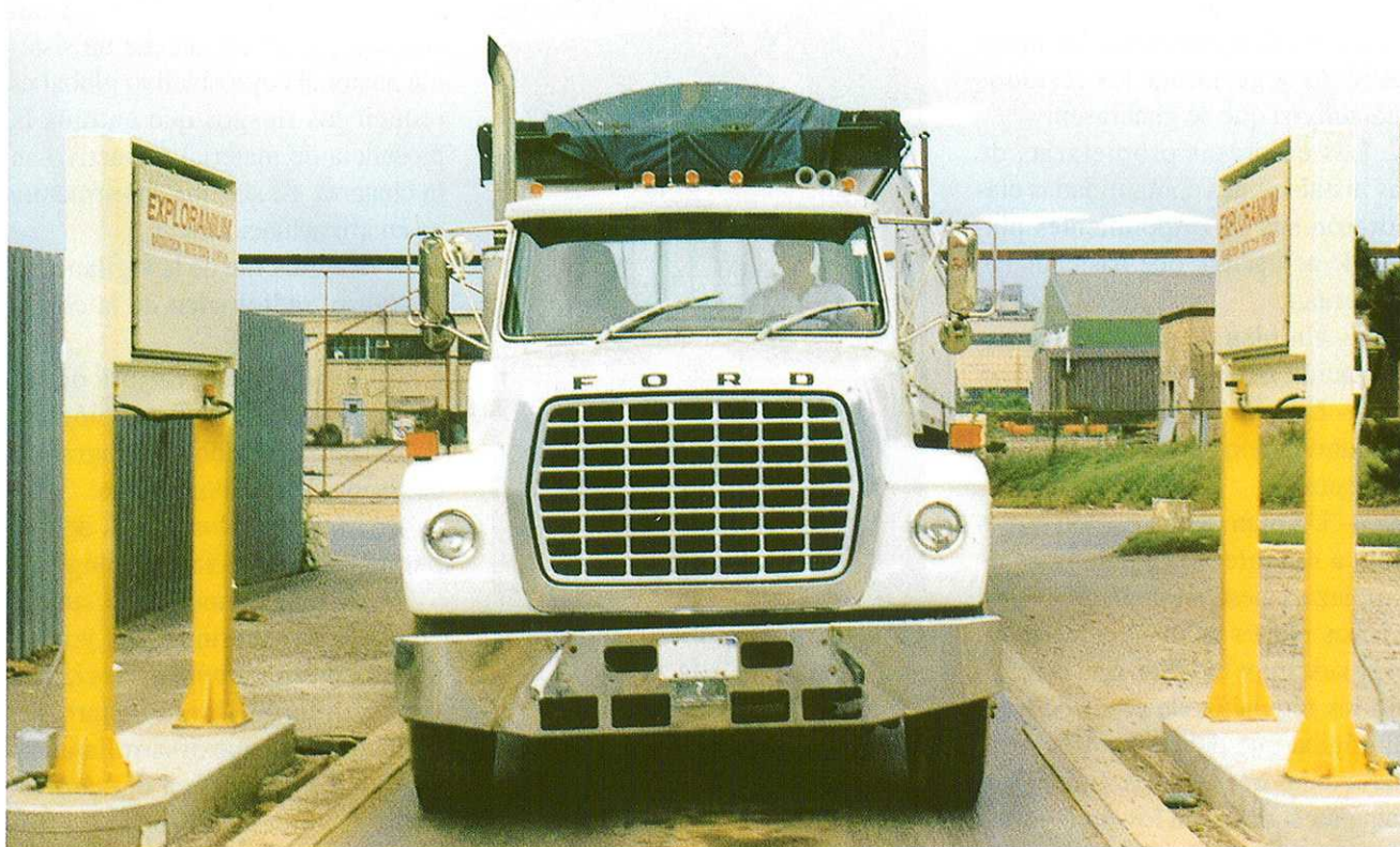
► Figura 1. Detector de pórtico para la inspección radiológica automática de camiones.
