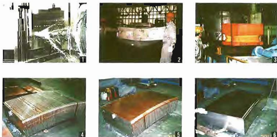
► Figura 4. Actividades de investigación y desarrollo realizadas en torno a la envoltura de ITER: 1. Perforación en acero de canales de refrigeración del blindaje. 2. Comado de conexiones de acero. 3. Bloque de acero tras el tratamiento térmico. 4. Ensamblaje de tubos de acero y placas de cobre. 5. Ensamblaje de blindaje y primera pared. 6. Encapsulado final.
