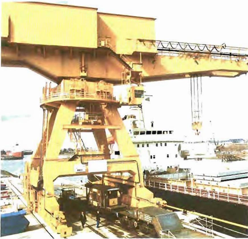
► Figura 1. Descarga de bultos con combustible nuclear gastado desde nave de transporte.
