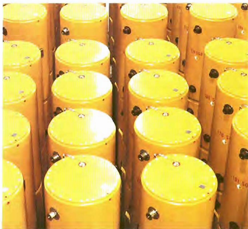
► Figura 3. Contenedores tipo CASTOR para almacenamiento de combustible gastado.
