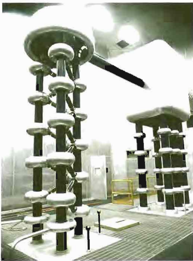
Figura 2. Generador eléctrico de tipo Cockcroft y Walton.
