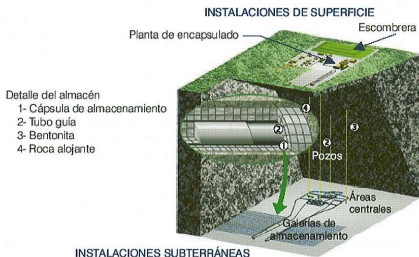
► Figura 2. Esquema de un Almacenamiento Geológico Profundo (AGP).
