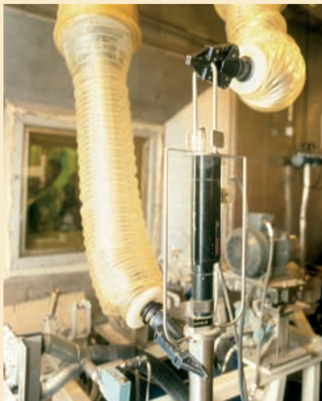
El Cabril. Laboratorio de caracterización activo. Telemánipuladores.
