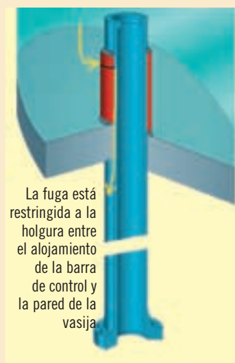
Figura 2. Camino de fuga.
