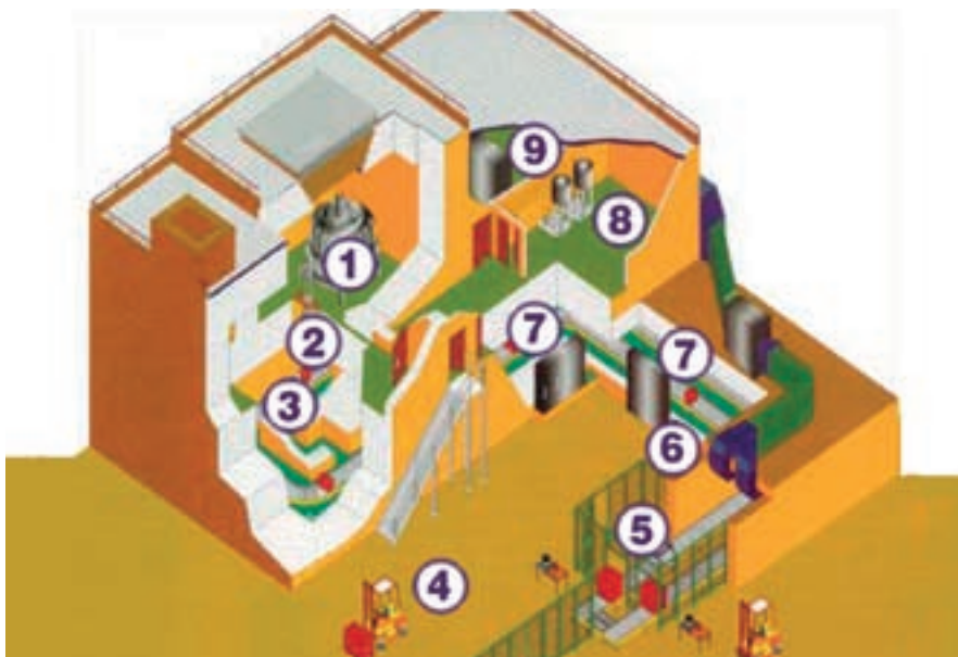
1. Acelerador de electrones ( Rhodotron ), 2. Colimador de electrones, 3. Zona de tratamiento, 4. Almacén, 5. Acceso a la cinta transportadora y Sistema volteador de los bultos, 6. Monitores de seguimiento, 7. Cinta transportadora con bultos, 8. Sistema de refrigeración del acelerador y 9. Sala de control. Obsérvense los gruesos muros de hormigón que actúan de protección radiológica cuando la instalación se encuentra en funcionamiento.
