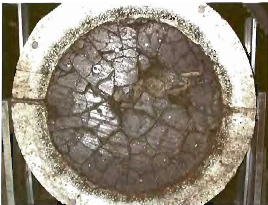
● Figura 6. Experimento SWICCS-3. Disposición de grietas en el corium tras realizar el experimento.
