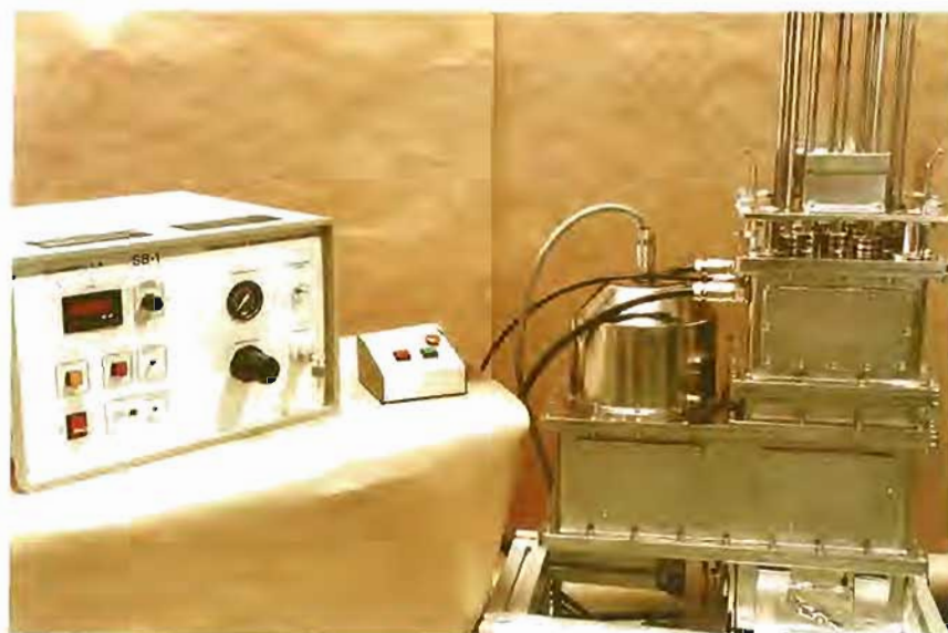
► Figura 4. Sistema de inspección de barras de control Sibaco.
