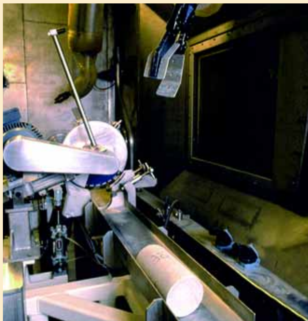
El Cabril. Laboratorio de caracterización activo. Celda de manipulación.
