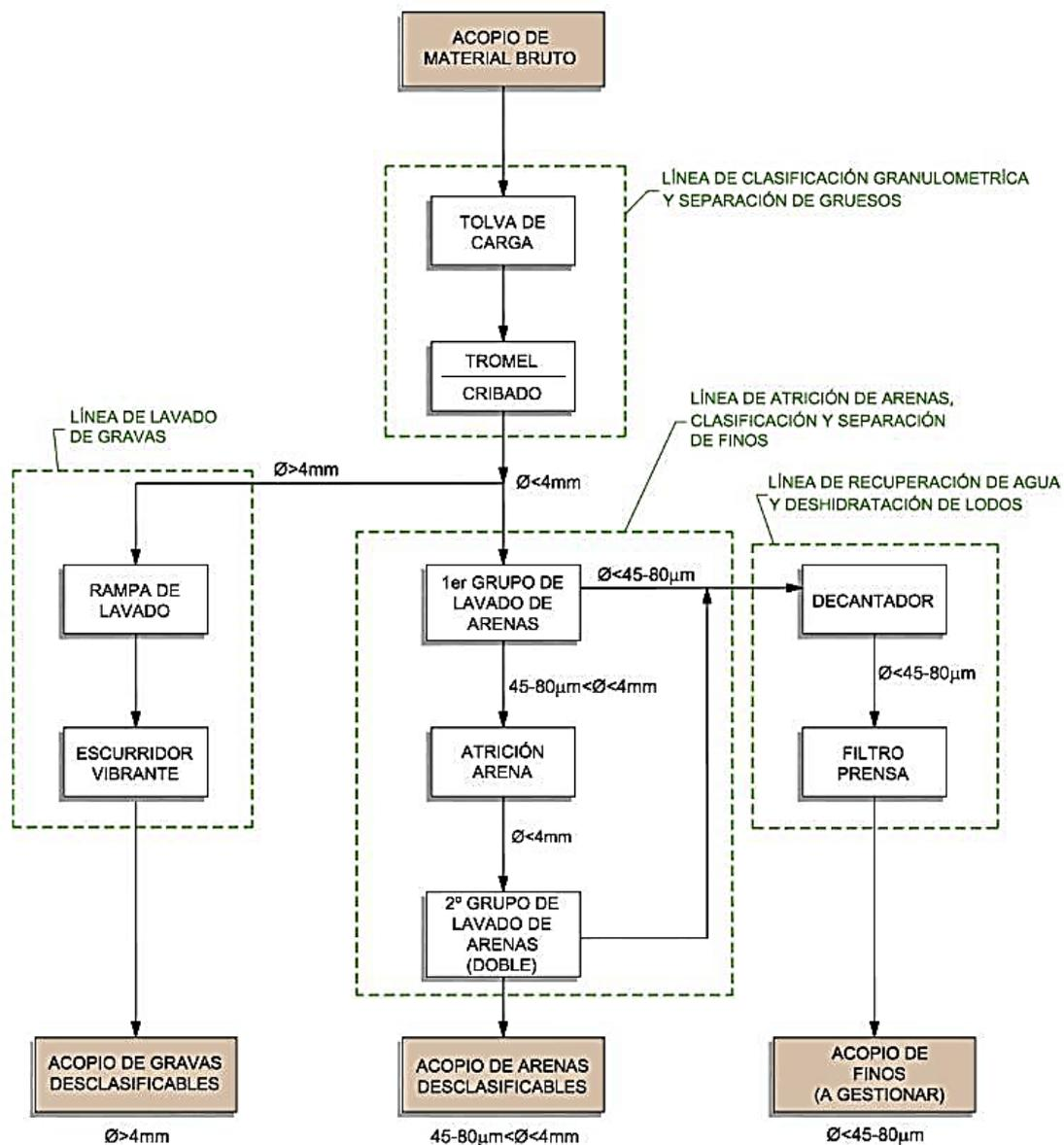
A lo largo del proceso se realizarán diferentes controles radiológicos en los acopios y en la planta de tratamiento de agua, con el fin de medir la efectividad de los diferentes procesos realizados y decidir la gestión final de los materiales (como desclasificable o como residuo radiactivo).
