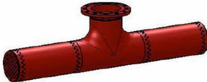
Figura 3: Cesta de entrada al SVFC en contención
