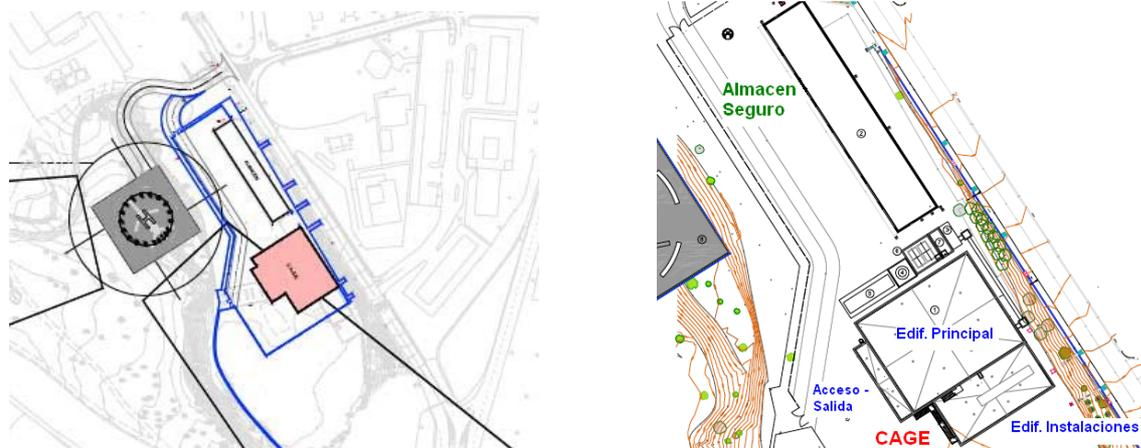
El CAGE consta de un edificio principal y de un edificio anexo para los equipos de ventilación, climatización y filtrado (Edificio de Instalaciones). El edificio principal del CAGE se organiza en dos plantas (Planta Baja + Planta Piso), ambas con una altura libre entre plantas de 4,00 m. Se ha diseñado para una dotación de 120 personas distribuidas en dos turnos de 60 personas.
