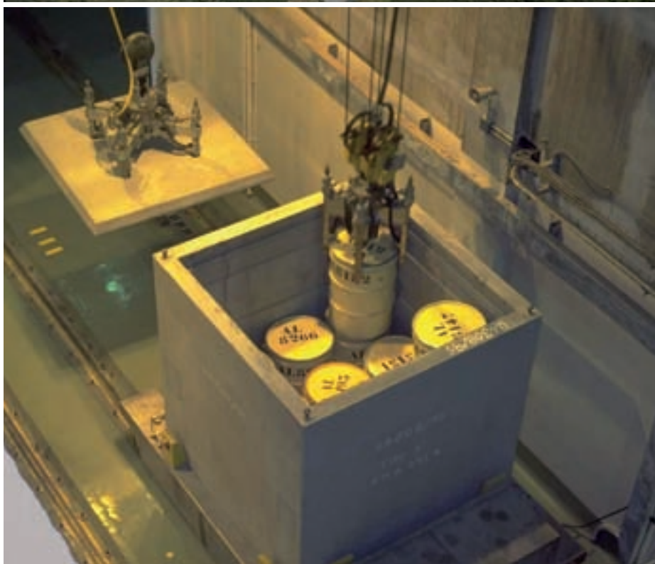
Vista aérea y detalle del manejo de residuos radiactivos en el Centro de Almacenamiento de El Cabril.
