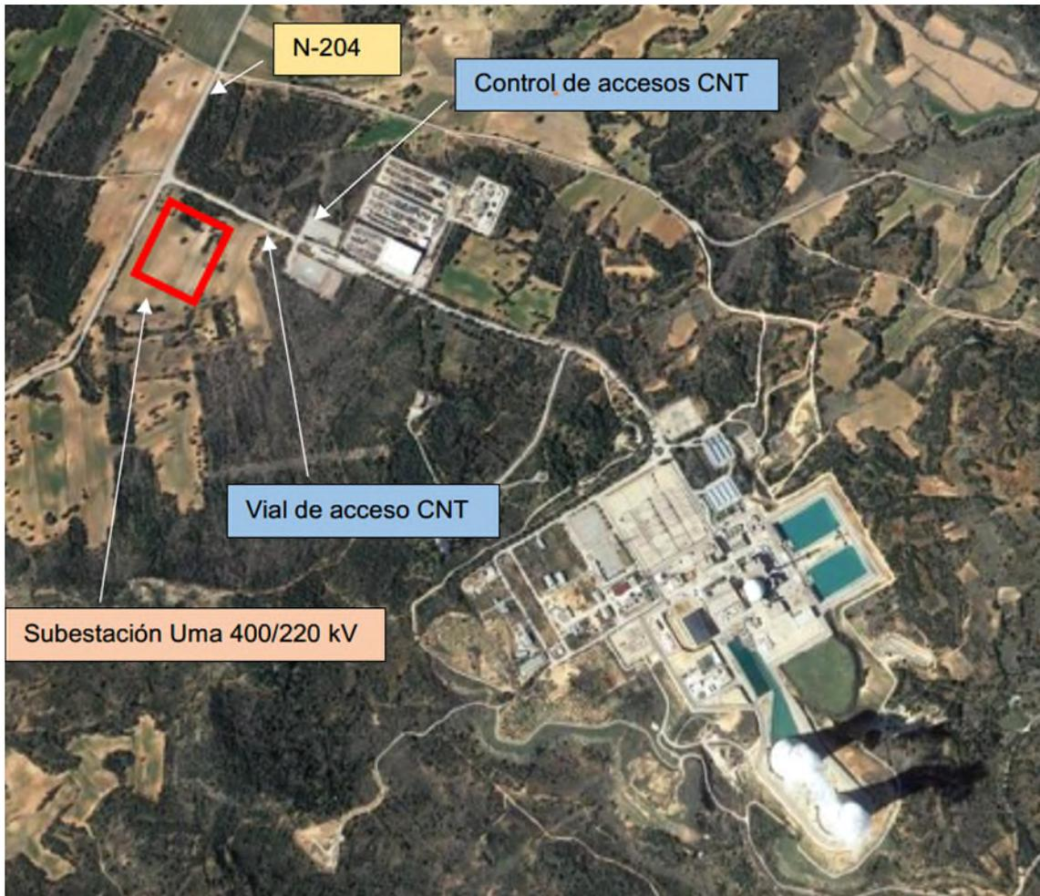
Desde la subestación UMA 400/220 kV saldrá una línea aérea a 400 kV hasta el punto de interconexión, situado en el parque de 400 kV de CN Trillo, punto final de la evacuación de toda la energía eléctrica generada por las 13 plantas fotovoltaicas.
