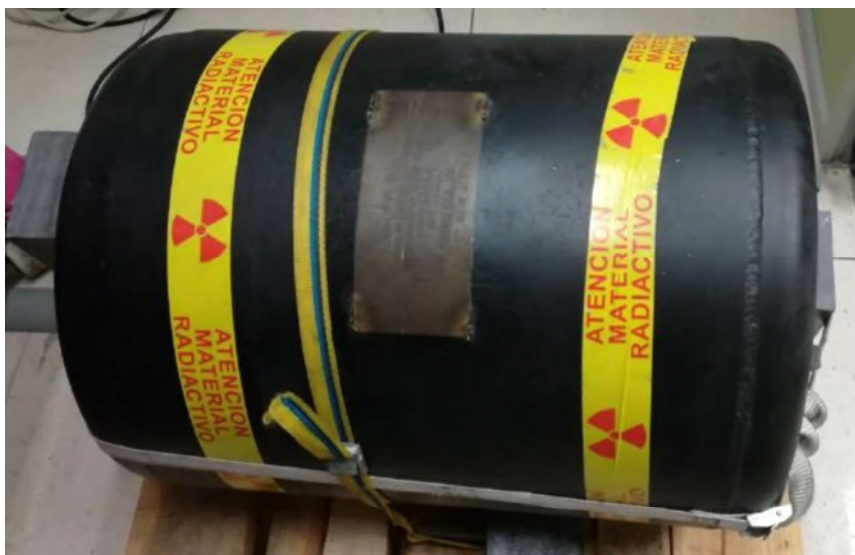
Figura 2. Irradiador GAMMACELL 1000 desmontado
