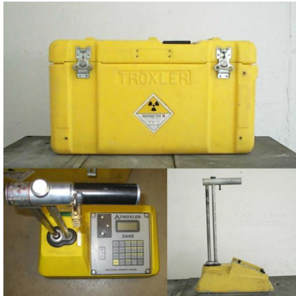
El equipo es de medida de densidad y humedad en suelos de la firma Troxler, Modelo 3411B N1 de serie 18190, de dos fuentes radiactivas, una de cesio-137 de 0,3 GBq y otra de americio-241/berilio de 1,48 GBq de actividad nominal máxima.
