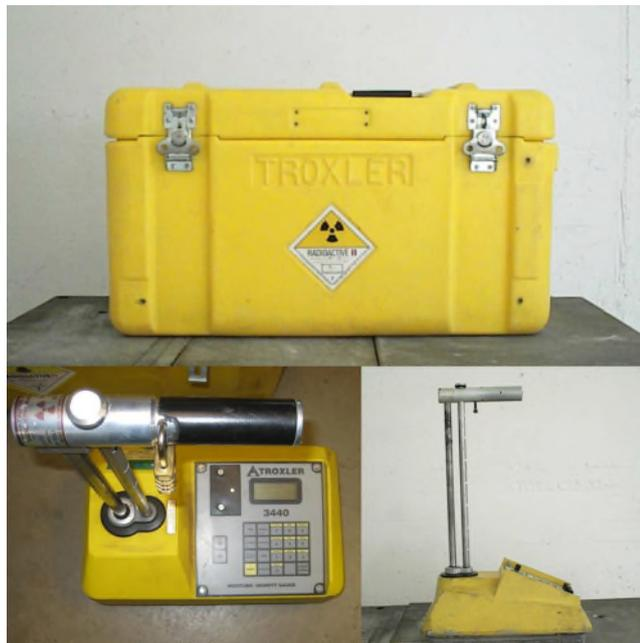
Para ayudar a identificar el equipo (se adjuntan fotografías), estos son de color amarillo con forma de caja, asa metálica en la parte superior, pantalla de cristal con un teclado numérico y un tubo metálico donde se aloja una de las fuentes radiactivas. El equipo y su maleta de transporte disponen de la señalización de material radiactivo (trébol y leyenda “Radiactivo”).
