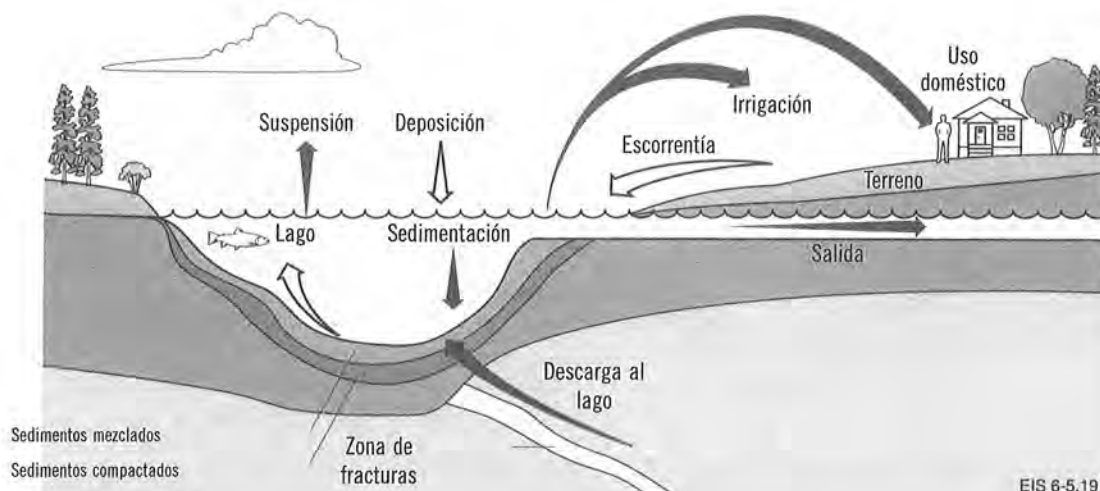
Figura 25. Procesos considerados en el modelo del lago y sus sedimentos en AECL-94 (Traducido de AECL-94 [2])
