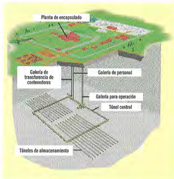
Figura 9. Vista general del sistema de almacenamiento del CI propuesto en Finlandia
