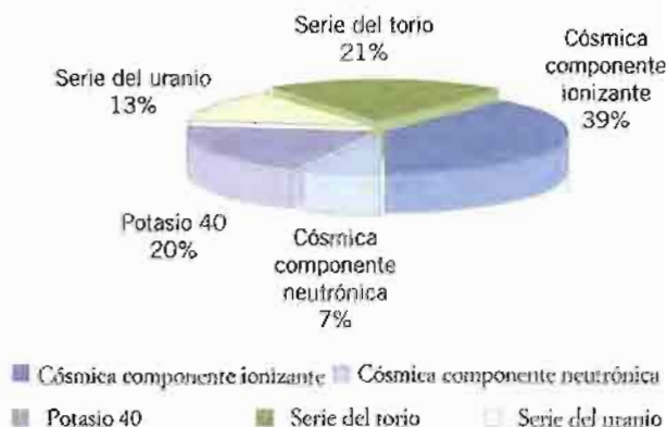
Figura 3.9. Contribución de la radiación externa a las dosis equivalente efectiva anual (0,8 mSv/año)
