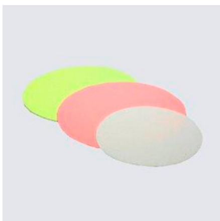
Figura 6: Distintos colectores de aerosoles para equipos de toma de muestras de bajo flujo.
