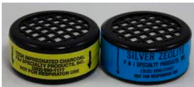
Figura 7: Colectores de radioyodos de un equipo de toma de muestras de bajo flujo.
