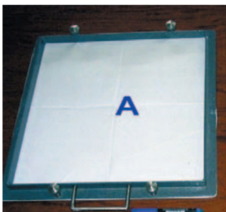
Figura 5: Sistema de captación (donde se ubica el colector) de un equipo de toma de muestras de alto flujo.
