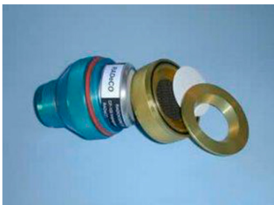
Figura 4: Despiece del sistema de captación o captador de un equipo de toma de muestras de bajo flujo con los colectores de yodo (cartucho, en color metálico) y de aerosoles (filtro, en color blanco).
