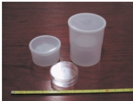
Figura 2. Recipientes de uso común para la espectrometría gamma de muestras de suelos
