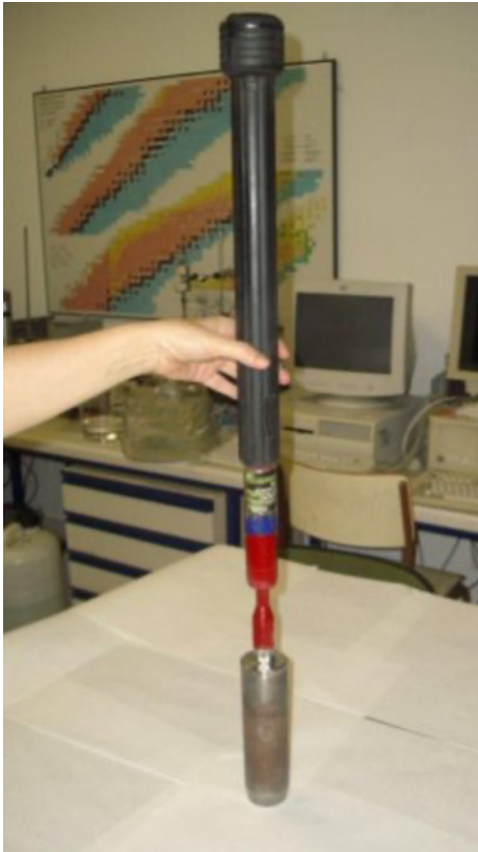
Figura 3. Cilindro de toma de muestras con martillo deslizante
