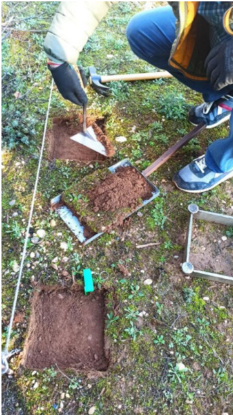
Figura 9: Extracción de suelo de la plantilla
