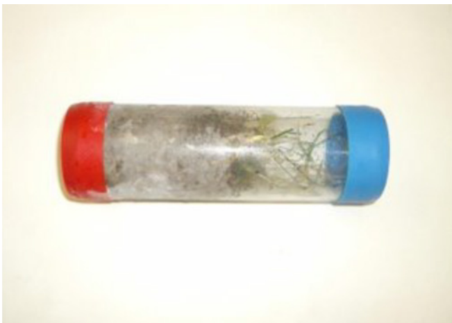
Figura 10: Suelo encapsulado en el liner
