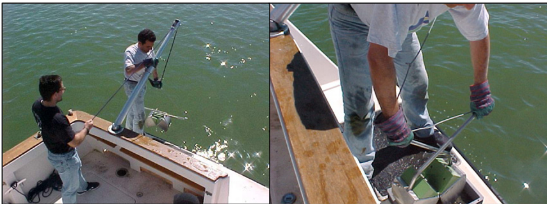
Figura 6: Extracción con muestreador tipo “draga”
