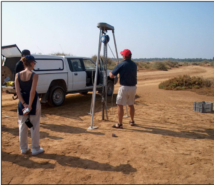
Figura 3: Extracción con muestreador tipo “cilindro”
