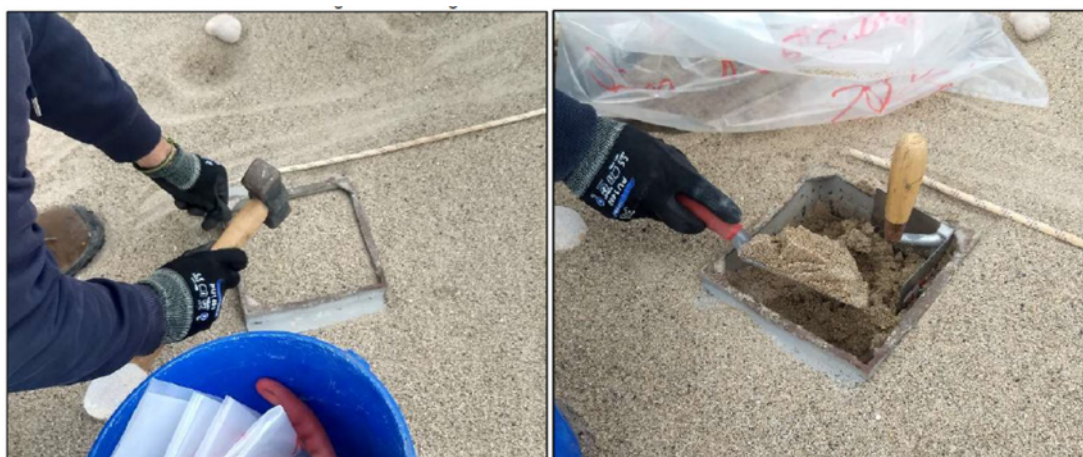
Figura 2: Utilización de plantilla para la extracción de sedimento de orilla (arena de playa).
