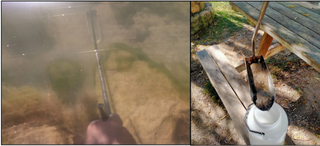
Figura 5: Pala de mediacaña con una altura de 5 cm.
