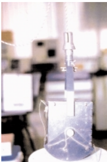
Figura 3. Ejemplo de draga para la recolección de sedimentos
