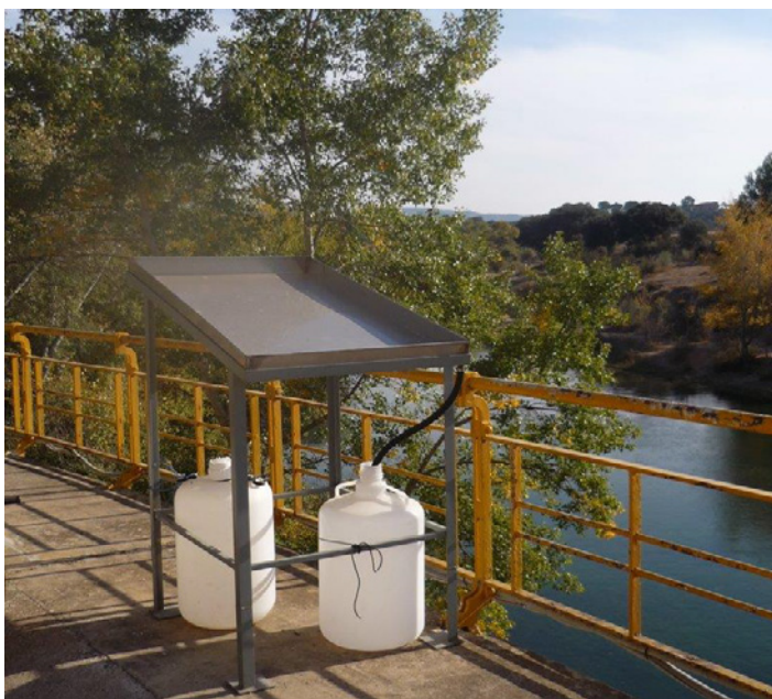
Figura 7. Colector de superficie con conducto y cubetas de almacenaje
