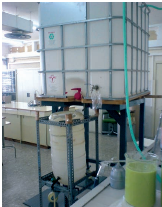
Figura 2.- Dispositivo experimental para la extracción del cesio de una muestra acuosa mediante su coprecipitación con AMP
